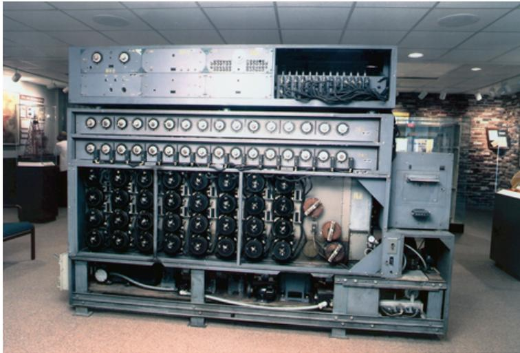
**Abbildung 4.9:** Die Hochgeschwindigkeitsvariante der Turing-Bombe, die speziell gegen die vierwalzigen Enigmas der deutschen U-Boote eingesetzt wurde.
