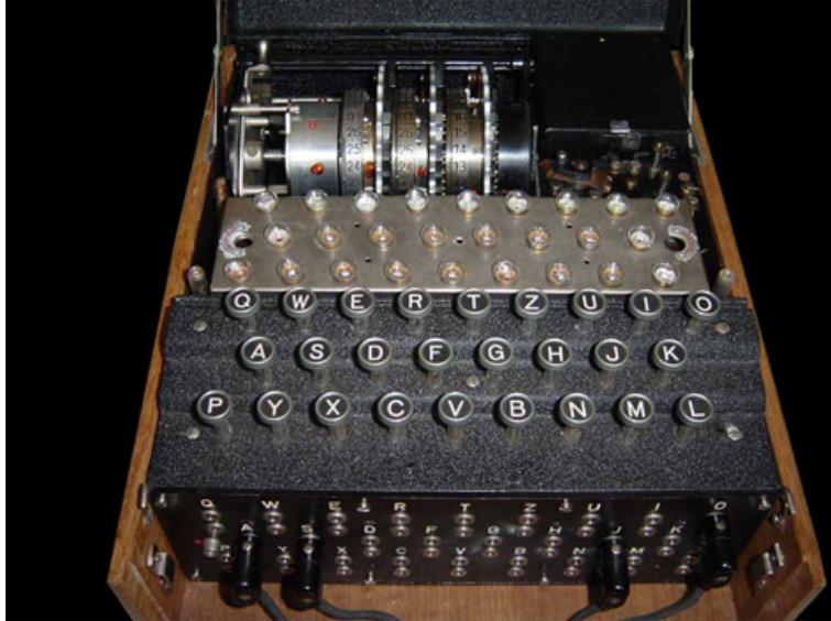
**Abbildung 4.1:** Eine Enigma ohne Abdeckung. Hinter der Tastatur befindet sich das Lampenfeld. Hinter dem Lampenfeld sieht man die drei Walzen; links davon die Umkehrwalze. An der Vorderseite der Enigma befindet sich das Steckerbrett.
