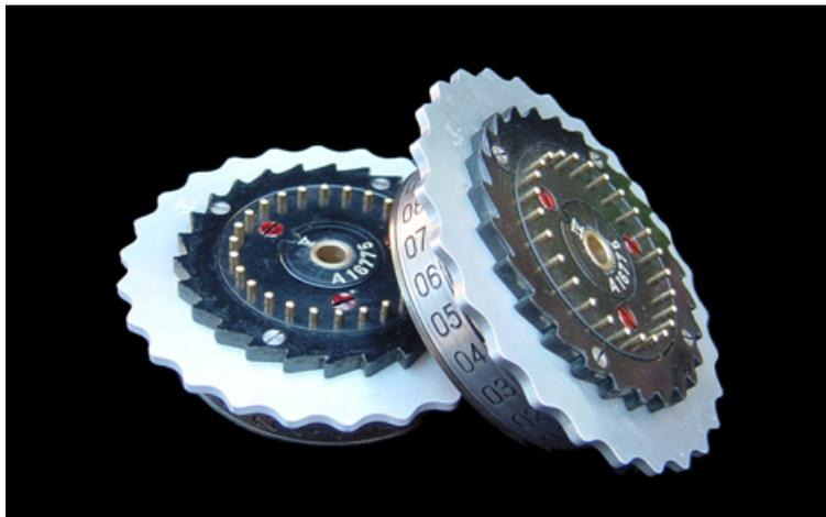
**Abbildung 4.2:** Zwei Walzen der Enigma. Man erkennt gut die 26 elektrischen Kontakte, sowie den beschrifteten Ring und das Zahnrad für die Fortschaltung der Walze.
